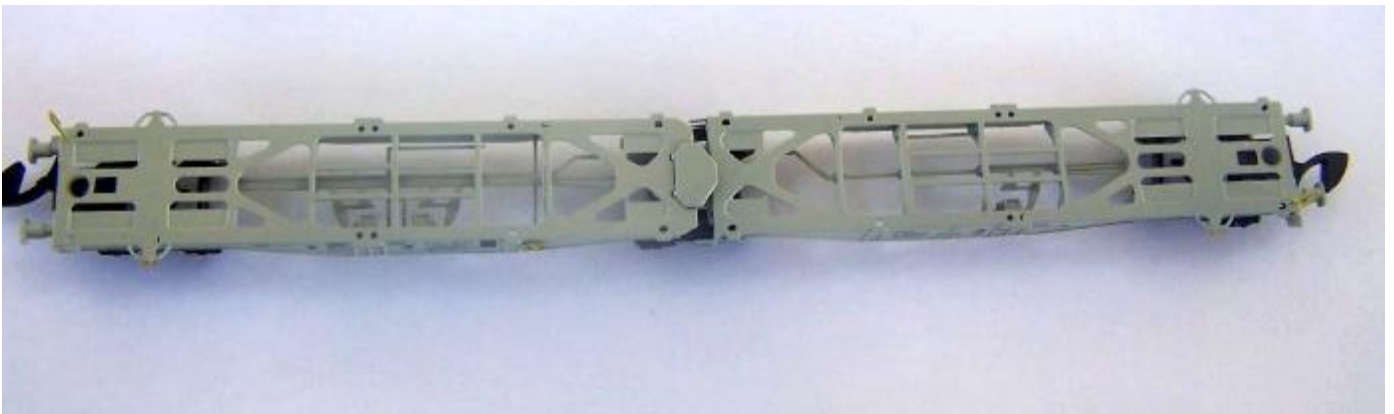
Die Ansicht des Modells von oben. Die Tragwerkstruktur ist originalgetreu nachgebildet, lediglich die Aufnahme der Modellcontainer ist der NEM380 angepasst.
