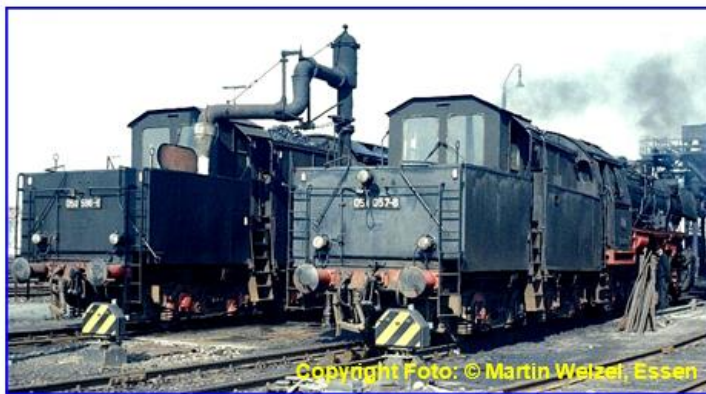
Gelenk-Wasserkran, Wasseraufnahme an zwei BR 050 mit Kabinentender, Hof 05/1973
