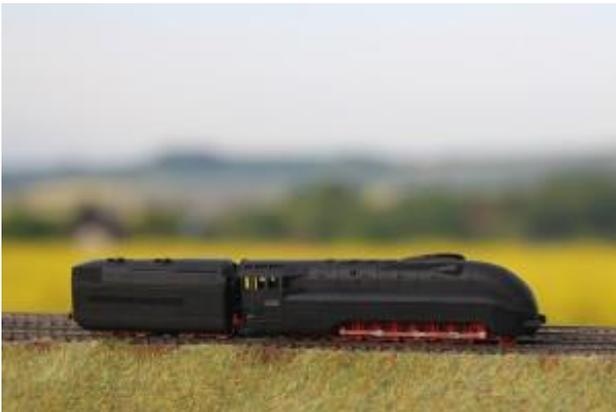
Das Modell hat einen Maxon-Glockenankermotor, gefrästes Messingchassis und Gehäuse aus Messingguss und befährt nur große Radien, weil wir die Form möglichst nicht durch die Aussparungen stören wollten. Beschreibungen der Lok und Zeichnungen finden sich in Wolfgang Stoffel, "Lokomotivbau und Dampftechnik" sowie Dirk Winkler, "Hochdruck- und Turbinenlokomotiven der Deutschen Reichsbahn-Gesellschaft".
