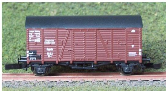
Die Güterwagen der Bauart Oppeln wurden von der DRG in großer Stückzahl beschafft, um Kriegsverluste und Reparationsleistungen nach dem 1. Weltkrieg zu ersetzen. Die Modelle haben ein Metallfahrwerk und ein Gehäuse aus Plastspritzguss mit angesetzten Griffstangen aus Edelstahl. Beide Wagen des Sets haben unterschiedliche Betriebsnummern.
