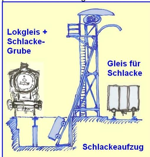
Komfortabler waren Schlackeaufzüge. Die Entsorgung der Schlacke erfolgte hier in „Förderkörben“, die auf Schienen laufend mit dem Schlackeaufzug aus der Grube nach oben gezogen wurden. Durch die obere bogenförmige Führung der Schienen fiel die Schlacke aus den Körben in die auf dem Gleis stehenden Schlackenwaggons, indem sich der Förderkorb durch die Bogenform automatisch auf den Kopf stellte.
