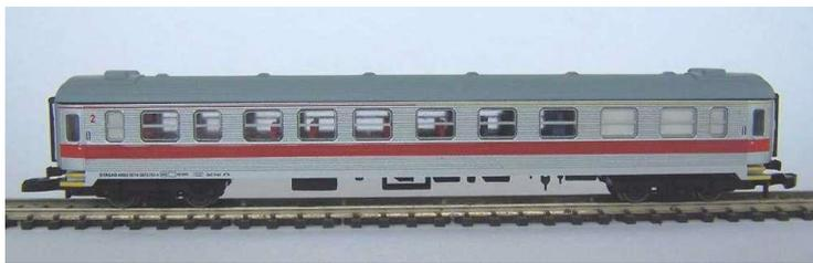
Das Vorbild dieses Modells wurde 1961 als reiner 2. Klasse Wagen Bo5 bei Kockums in Malmö für die Schwedische Staatsbahn SJ produziert. 2009 gelangte der Wagen zur TAGAB und wurde aufwändig umgebaut. Durch Einfügen von Trennwänden und neuer Bestuhlung entstand ein 1. Klasse Großraumabteil und ein Kiosk. Die Sitzplatzzahl in der 2. Klasse reduzierte sich dadurch auf 28. Das Modell entspricht in den technischen Eigenschaften dem Artikel 46.221.02 und ergänzt diese.
