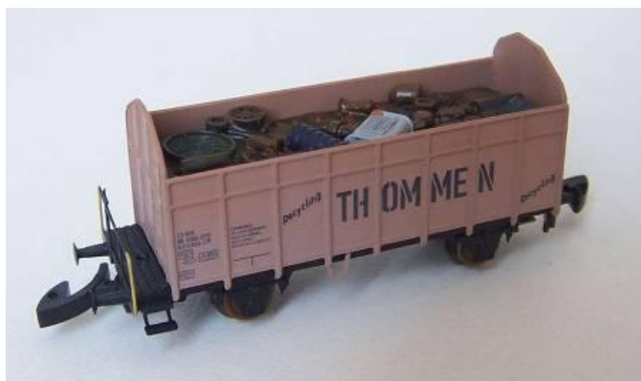
Offener Güterwagen für den Transport von Metall-Schrott der Fa. Thommen. Das Originalfahrzeug hat einen komplett verschweissten Laderaum, der das Auslaufen von Altöl u.ä. und damit eine Bodenkontamination verhindert. Dieses Modell und neu gestalteter Schrottladung.
