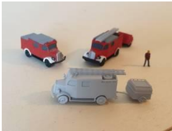
Links FDM Druck rechts SLA (1.) vorne überarbeitete Version (2.)
