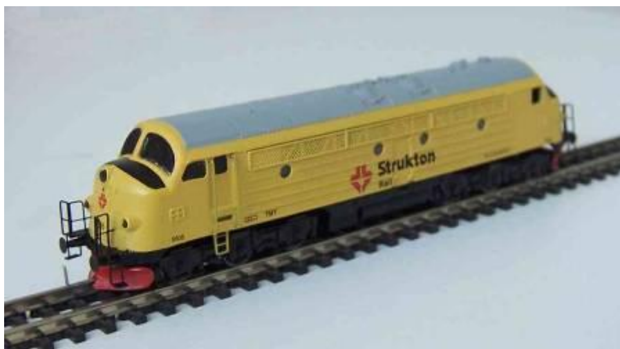
Sechssachsiges Diesellok Bauart TMY eingestellt bei STRUKTON Rail / Schweden. Das Modell hat einen Antrieb mit Maxon-Motor und Schwungmasse auf alle Achsen.
