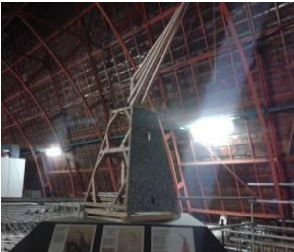
Der mittelalterliche Baukran
