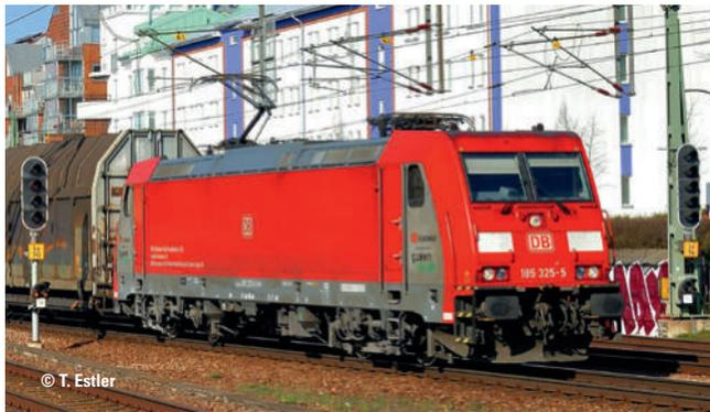
**Vorbild:** Elektrolokomotive Traxx 2, Typ F 140 AC2 der Firma DB Schenker Rail Scandinavia A/S, einer Kooperation zwischen der DB Schenker Rail Deutschland AG und der schwedischen Green Cargo AB. Betriebszustand 2017/18. Einsatzgebiet Dänemark und auch bis nach Deutschland hinein.
