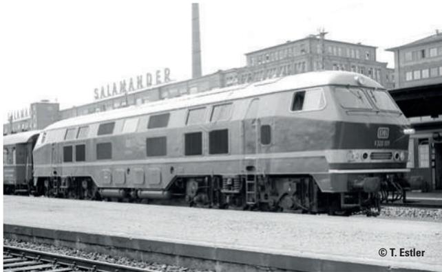
**Vorbild:** Diesellokomotive V 320 001 der Deutschen Bundesbahn (DB) in purpurroter Farbgebung der Epoche IIIb. Zustand um 1965.
