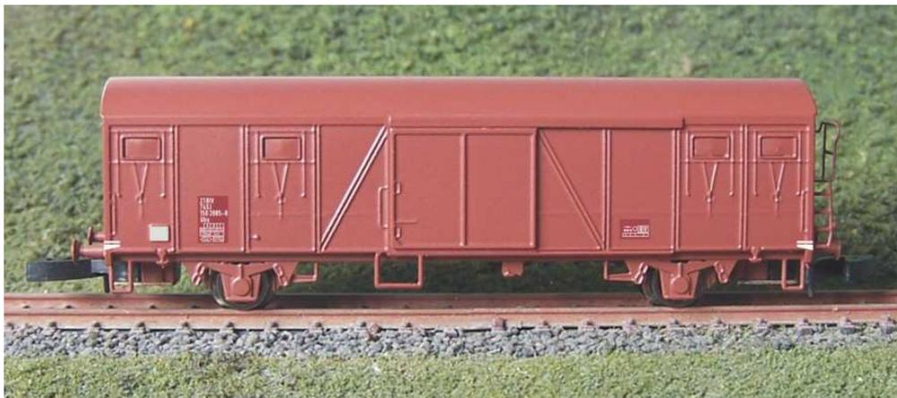
Das schwedische Modell weist alle Besonderheiten des Vorbilds auf: die plastischen, Lüftungsschieber in unterschiedlichen Abständen auf jeder Seite und die hochgesetzte Bremserplattform mit innenliegender Bremskurbel.
