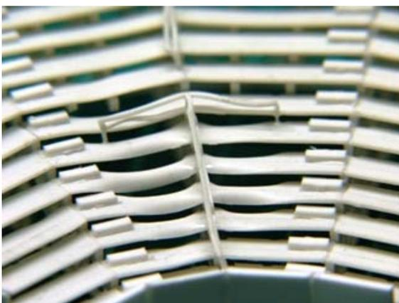
Im Bereich der geraden Tribünenteile stellte die Montage kein Problem dar. In den 90° Kurven jedoch, hatte ich den Ehrgeiz die Werbebänder zu biegen und der Rundung anzupassen. Dazu erwärmte ich das Material mit einem Heißluftgebläse. Allerdings geriet ein Tribünensegment in den Abgasstrahl. Das Ergebnis ist links zu sehen – und es war beileibe nicht das letzte Mal, dass ich in meiner Werkstatt unflätige Kraftausdrücke von mir gab.
