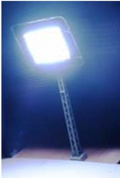
Die Drähte ließen sich zwar parallel spannen, verformten sich aber nach dem Anlöten der LEDs. In der Folge leuchteten die LEDs in alle möglichen Richtungen nur nicht in die gewünschte.
